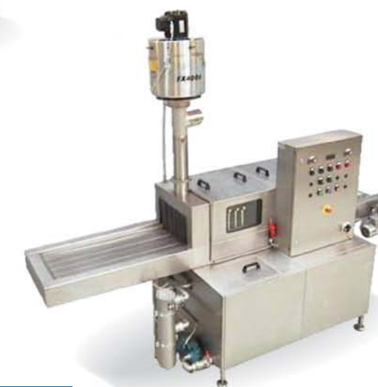
Automatická průchozí trysková myčka 2-zónová pro mytí malých součástí. Viditelný kondenzační systém (na prání)
